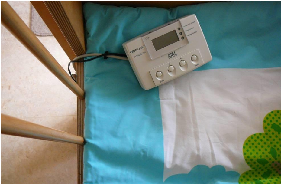
Foto 2. Meetopstelling in een binnenbedje: de meter aan het hoofdeinde, de datalogger met het snoer door de spijlen aan de buitenkant.
