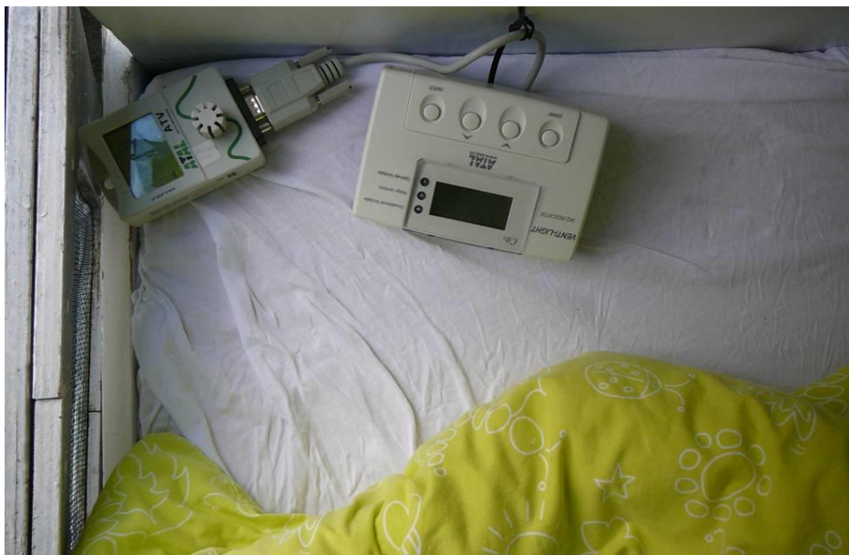
Foto 3. Meetopstelling in een buitenbedje: meter en datalogger bij het hoofdeinde en het snoer omhoog, via de bovenkant van de voorklep naar buiten.
